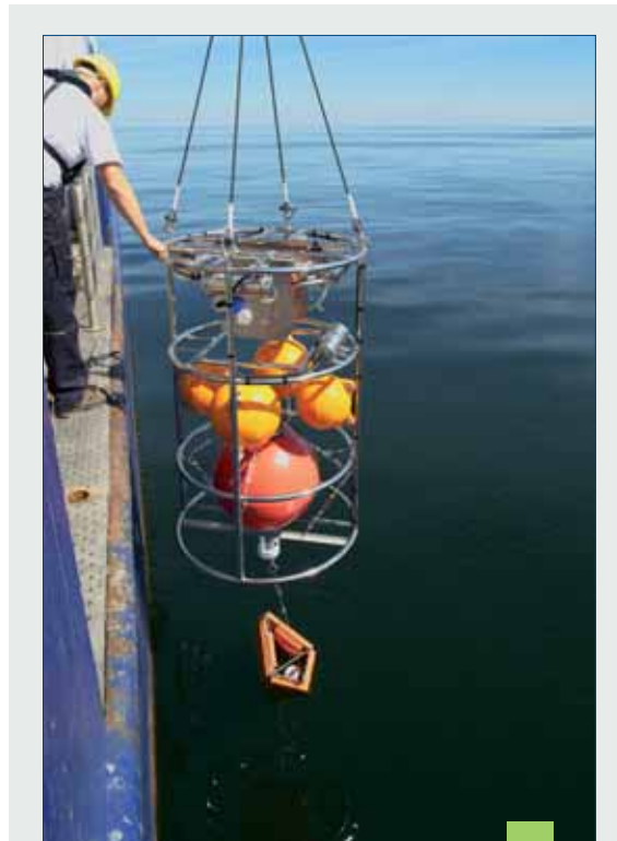
GODESS - DIE UNTERWASSER-WINDE (OBEN) UND DIE PROFILIERENDEN MESSGERÄTE (UNTEN) WERDEN AUSGESETZT. / DEPLOYMENT OF THE UNDERWATER WINCH (TOP) WITH THE PROFILING BODY (BOTTOM). (FOTO: IOW)
